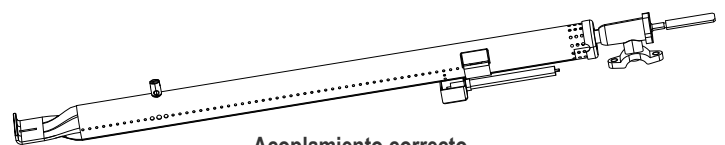
Acoplamiento correcto del quemador con la válvula
