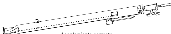
Acoplamiento correcto del quemador con la válvula
