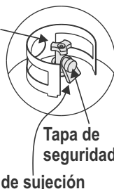
Válvula del tanque de gas
