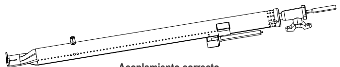
Acoplamiento correcto del quemador con la válvula
